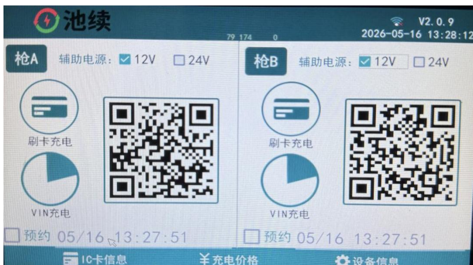
c. 用户扫码启动 A 枪充电后，充电中的界面，如下图
