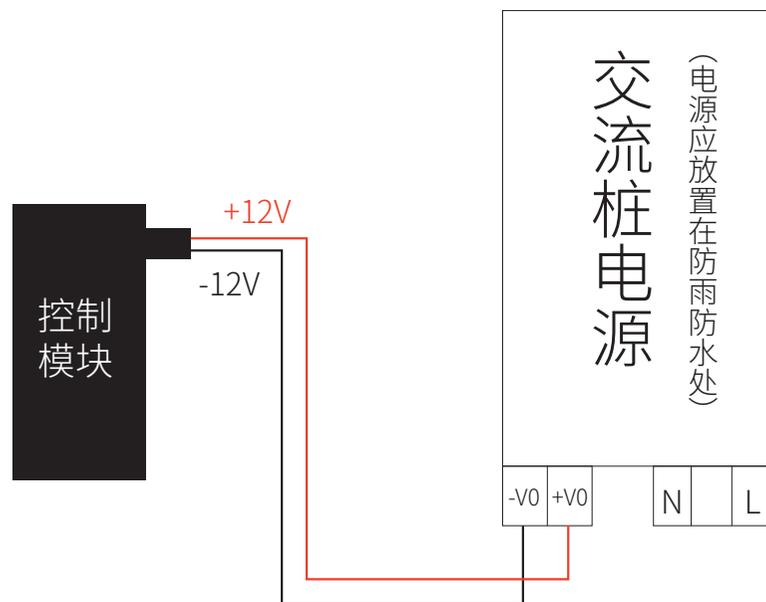
地锁电源线红色为+12V, 黑色为-12V, 分别按照极性(主板上有标注)连接到地锁电源正负极端子处。
