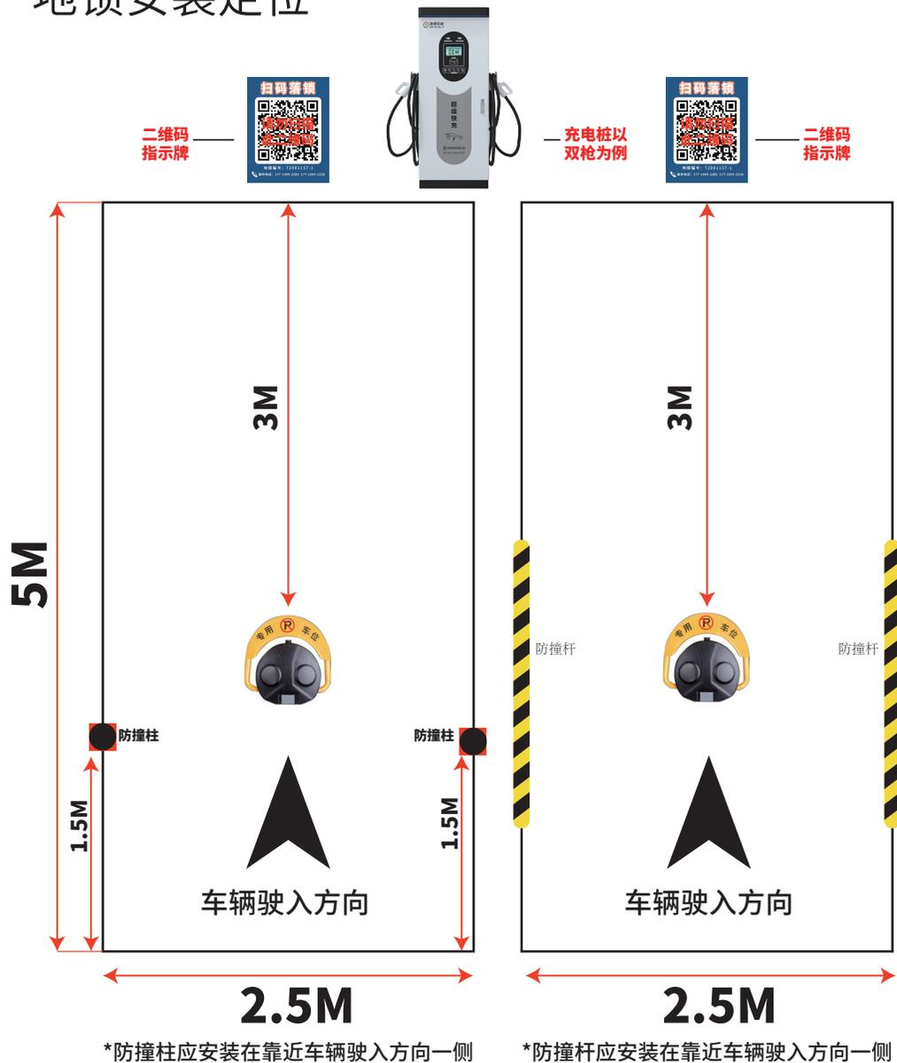
以2.5m\*5m的标准停车位为例,地锁安装应在车位中心靠近车辆驶入方向位置。
