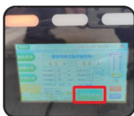
⑤ 充电完成后点击屏幕界面“停止充电”并按下 V2V 充放电器右侧开机键将机器关机。
