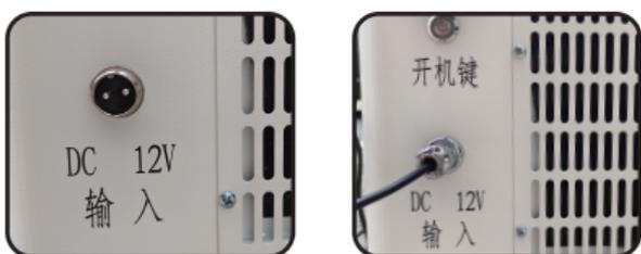
③ 先将右侧输入口枪头插入救援车辆（放电车）直流充电口在按下 V2V 充放电器右侧开机键。
