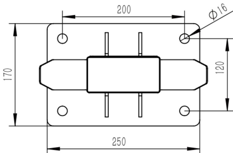
将固定板对准立柱螺丝孔位安装固定，将挂板对准桩体后方螺丝孔位安装挂板，随后将桩体挂在固定板上，并使用 M4 螺丝限位。
